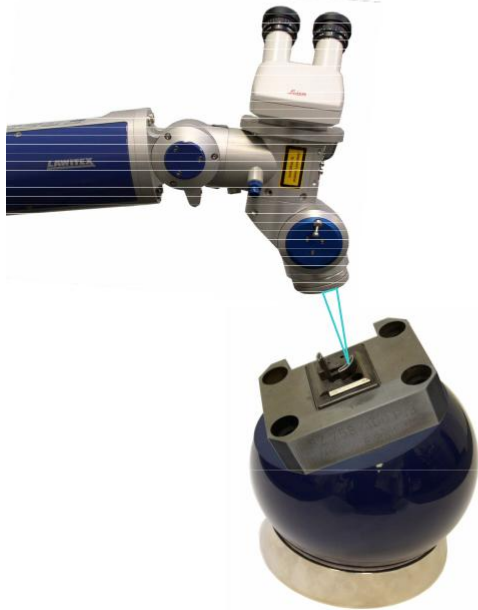
Laserschweißen an der Kontur Fokussierobjektiv 150 mm
