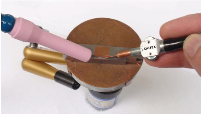
Schnelle und genaue Positionierung der Werkstücke mit dem Flexarm.
