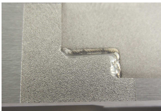
Fehlerfrei erodierte Fläche mit LAWI 62 EROD beschweißt.
